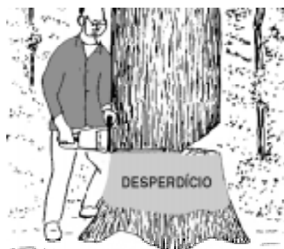
Figura 11. Erro na altura do corte.
